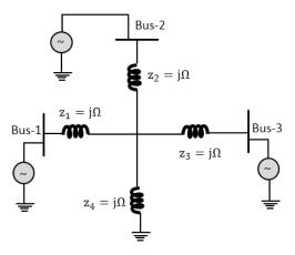
$$\begin{aligned} V_1 &= j1i_1 + j1(i_2 + i_2 + i_3) \\ V_1 &= 2ji_1 + ji_2 + ji_3 \\ V_2 &= ji_1 + 2ji_2 + ji_3 \\ V_3 &= ji_1 + ji_2 + 2ji_3 \\ \begin{bmatrix} V_1 \\ V_2 \\ V_3 \end{bmatrix} = \begin{bmatrix} 2j & j & j \\ j & 2j & j \\ j & j & 2j \end{bmatrix} \begin{bmatrix} i_1 \\ i_2 \\ i_3 \end{bmatrix} \\ Z_{bus} &= \begin{bmatrix} 2j & j & j \\ j & 2j & j \\ j & j & 2j \end{bmatrix} \begin{bmatrix} i_1 \\ i_2 \\ i_3 \end{bmatrix} \end{aligned}$$
